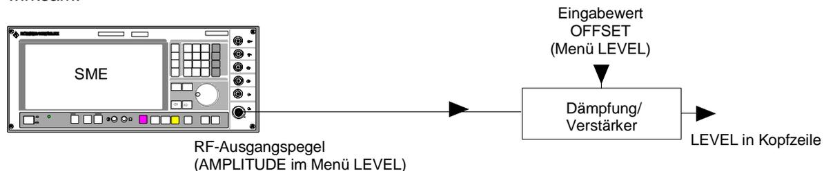
Bild 2-19 Beispiel für eine Schaltung mit Pegeloffset
