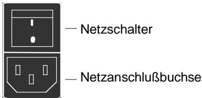
Netzschalter an der Geräterückseite
